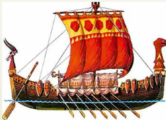
Ладея Древней Руси. В XIII веке на Руси использовались разные типы ладей — парусно-гребных судов, предназначенных для торговых плаваний и боевых походов. Новгородские ладей — длина около 20 м, ширина 4,5–5,5 м, осадка 2 м. На съёмной мачте поднимался один прямой парус площадью 70–80 м 2 , орнаментированный стилизованным крестом. В случае безветрия использовались вёсла
